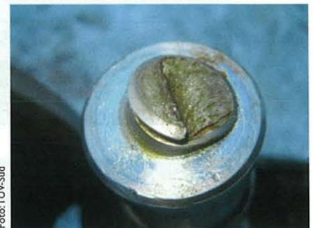
Abb. 3: Bruchbild am Gewindeansatz der Führungsrollenachse
