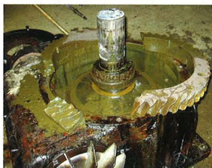
Der Zahnkranz der Antriebswelle des als Schneckengetriebe ausgeführten Hauptgetriebes war gebrochen.
