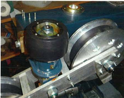
Abb. 4: Führungsrolle mit Sicherungsmutter (neu)
