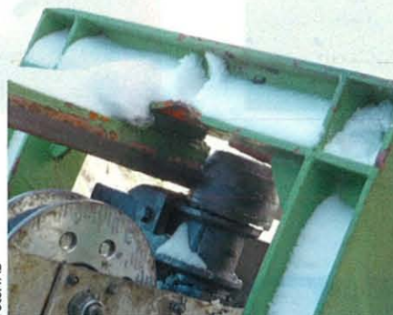
Abb. 2: Schadensbild am Querträger mit Führungsrolle
