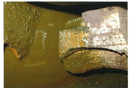
Eine der Bruchflächen des gebrochenen Zahnkranzes
