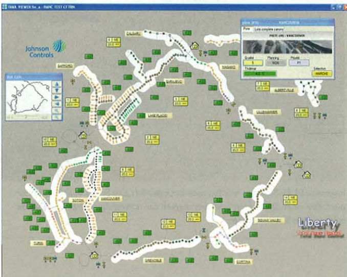
Bildschirmdarstellung der Pisten und Elemente der Beschneigungsanlage („TrailView“)
