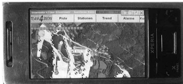
Durch den Remote-Zugriff kann die Beschneigungsanlage sogar vom Mobiltelefon aus gesteuert werden.
