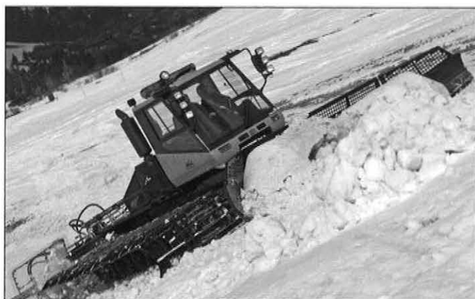
GALAXIT: Mit 446 PS und 5 m Fräs-Breite das stärkste AZTEC-Fahrzeug
