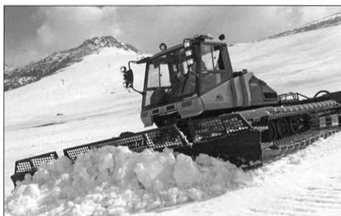
CANONIT: Mit dem CATERPILLAR-Motor C9 eine Leistung von 330 PS
