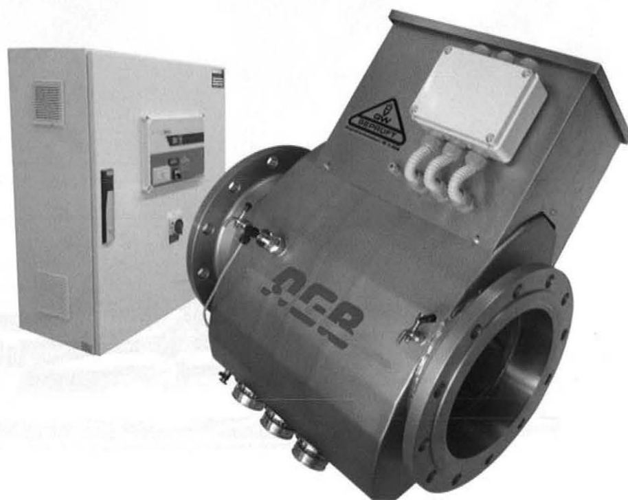
UV-Entkeimung mit Steuergerät (Type TM4500). Diese Mitteldruckanlage hat eine Durchflussleistung von 805 m 3 /h bei 60%, die Anschlussdimension ist DN 300.
