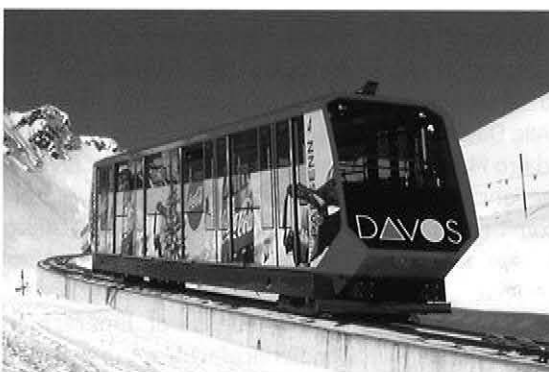
Zwei grössere Standseilbahnwagen (110 Personen) wurden im letzten Sommer für die zweite Sektion der Parnsbahn in Davos erstellt.
