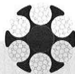
Litzenseil mit Profilen und Kern aus Kunststoff.
