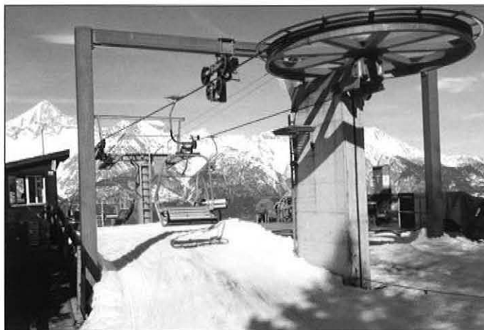
Aus „alt“ mach (fast) „neu“ beim fixen 2er-Sessellift Unterbäch - Brandalp: Der von der BMF AG durchgeführte Umbau umfasste die Stützenköpfe, die Rollenbatterien, die fixen Klemmen und die Umlenkscheibe am Berg - dazu wurden die Fahrbetriebsmittel erneuert.
