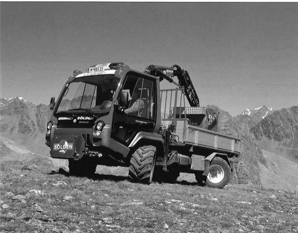
Der Designtransporter aus dem Tiroler Unterland überzeugt neben Gemeinden und Landwirten auch die Seilbahner-Profis unter anderem mit der Fahrerkabine, die ohne Geräte-Einsatz komfortabel seitlich um 50 Grad kippbar ist.
