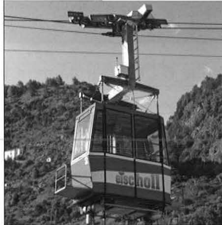
Die Luftseilbahn Raron-Eischoll im Wallis ist eine der drei begutachteten Anlagen und ein „klassisches“ Beispiel für die Anforderung bei der technischen Bewertung älterer Seilbahnen: Baujahr 1946 (VON ROLL), Umbau 1989, 2006 und 2010. Fotos: tytec
