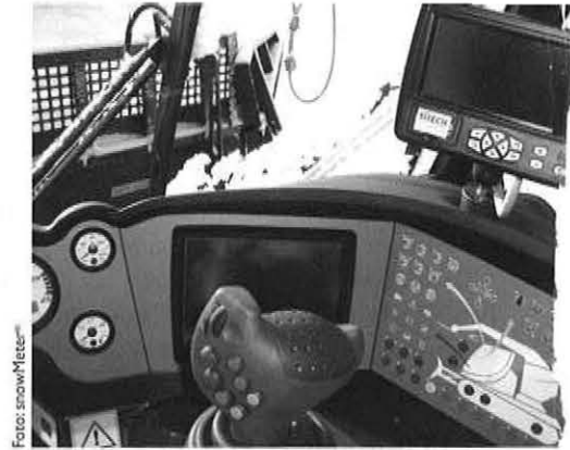
Das Ergebnis der Schneehöhenmessung wird optisch in Echtzeit auf einem Bildschirm (re. i. B.) in der Fahrerkabine angezeigt.
