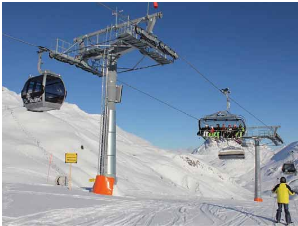
Im Kombi-Betrieb Sessel & Kabine wird eine Gesamt-Förderleistung von fast. 3.900 P/h erreicht
