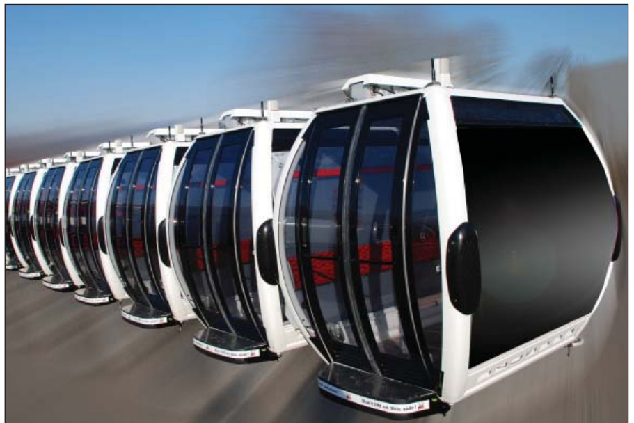
36 OMEGA IV-10 LW für die London Cable Car entstehen in den CWA-Werkstätten.
