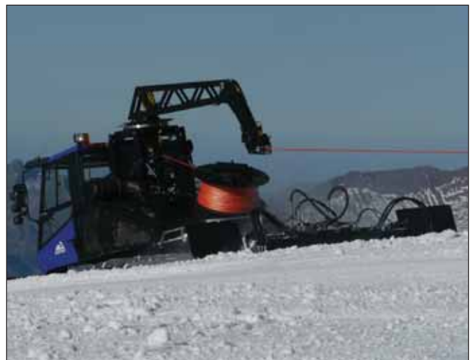
Die Lösung aller Probleme bei der Winden-Präparierung? Das Kunststoff-Seil ist leichter und besser sichtbar als Stahlseile.
