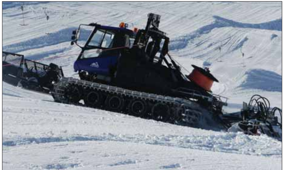
Hier gut zu sehen: Die neue versenkbare Winden-Lösung.
