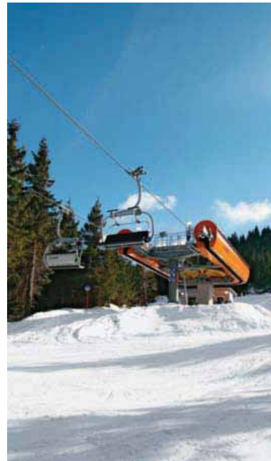
Die kurze Station von Leitner als fixe Umlenkstation für kuppelbare 4er- und 6er-Sesselbahnen mit niedriger Stationsverkleidung
