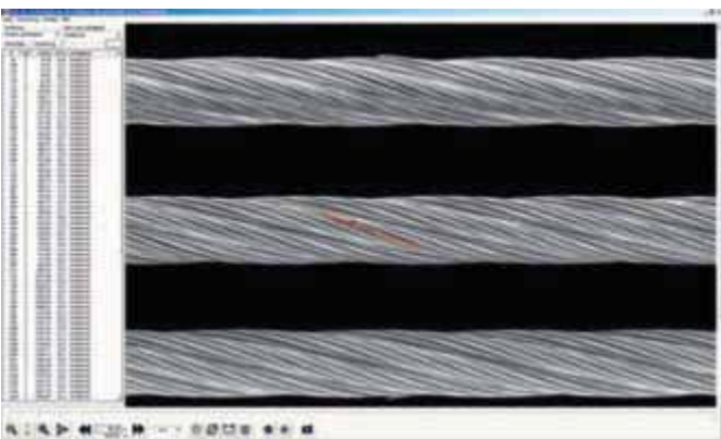
Markierung und Anzeige eines automatisch detektierten Fehlers
