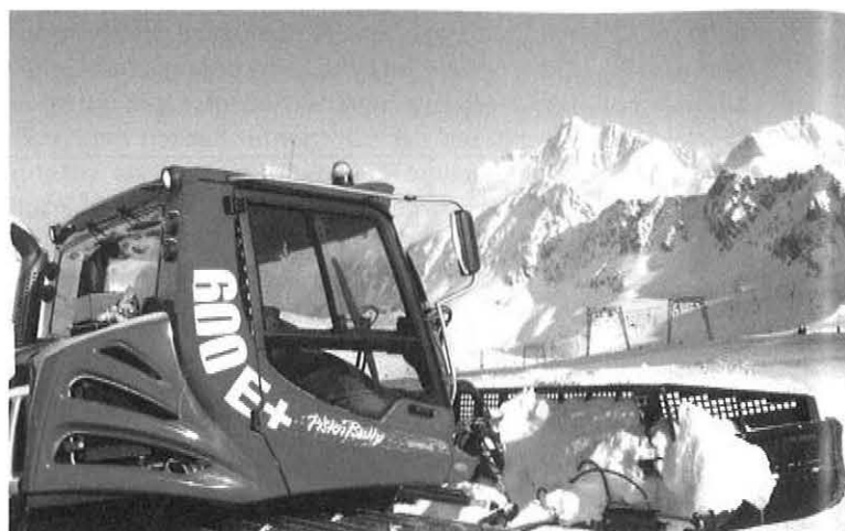
PistenBully 600 E+ – das erste Pistenfahrzeug mit dieselektrischem Antrieb im alpinen Einsatz.
