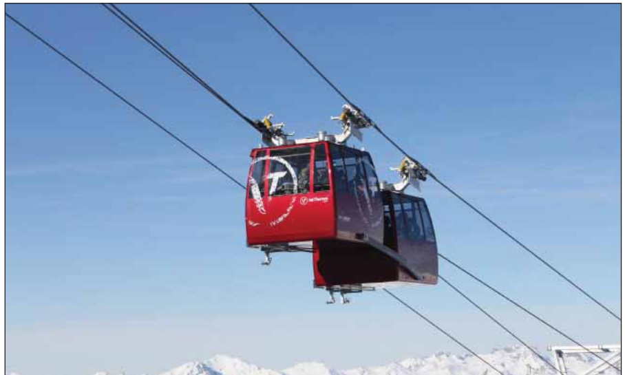
Wie auf „Schienen“: Die beiden parallel geführten Förderseile für besondere Wind-Stabilität.
