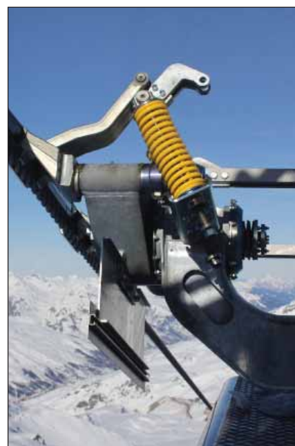
Die innovative BMF-Klemme für die Fix-Verklemmung mit den beiden Förderseilen.
