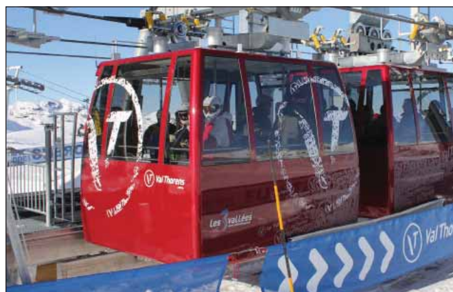
Die von GANGLOFF gelieferten Kabinen bieten Platz für je 33 Personen und können damit bis zu 1.500 Personen pro Stunde befördern.
