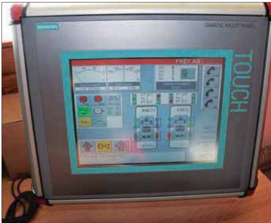
Touchpanel statt Knöpfen - der Stand der Technik moderner Seilbahn-Steuerungen.
