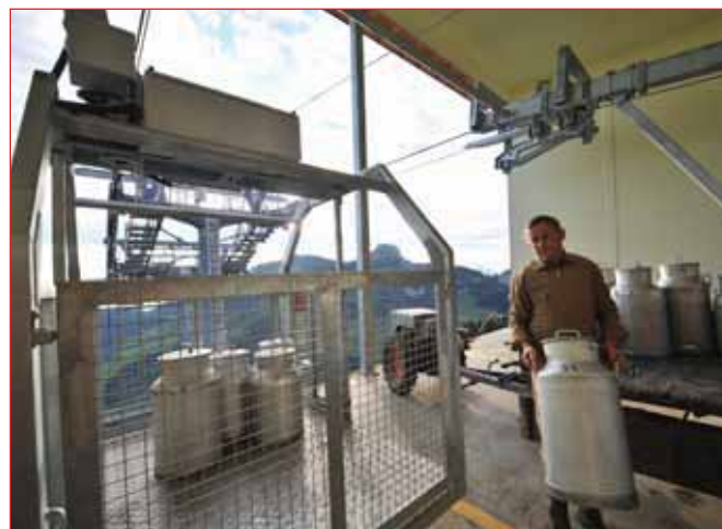
Kompakt-Seilbahn: Kann auch für eine Bedienung ohne Personal konzipiert werden und ist einfach auf einen Lastentransport umstellbar.
