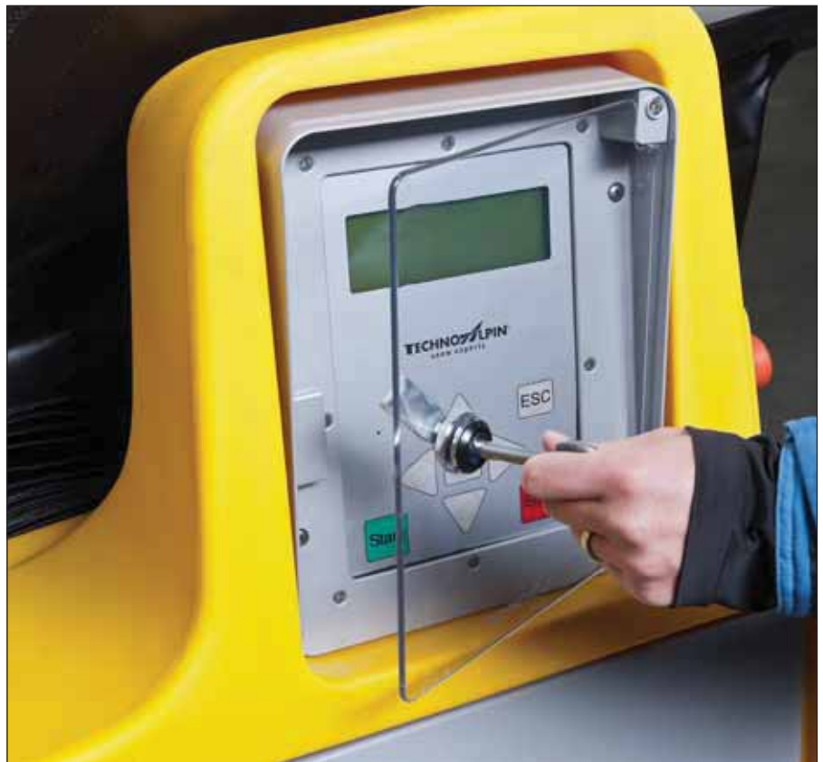
Die neue vollautomatische Propellermaschine TF10: Die Tastatur verfügt über eine serienmäßige LED-Tastenbeleuchtung sowie über einen Regenschutz und eine Anti-Vandalismus-Vorrichtung.
