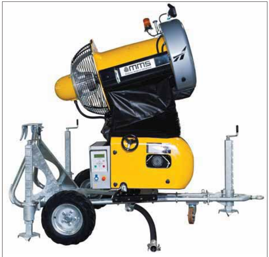
Die MMS (Manual Mobile Snowgun) ist als mobiler manueller Schnee-Erzeuger ausgelegt. Dabei wurden Bedienung und Regelung wesentlich vereinfacht.
