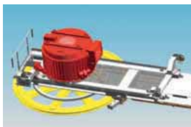
Abb. 3: Schemazeichnung des Leitner-Direktantriebes auf verschiebbarer Antriebsbrücke
