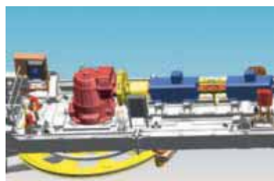
Abb. 1: Schemazeichnung des Leitner-Oberflurantriebes mit zwei Elektromotoren in Tandemanordnung
