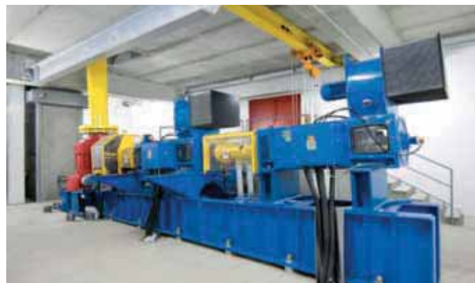
Unterflurantrieb mit zwei fremdbelüfteten Gleichstrommotoren in Tandemanordnung
