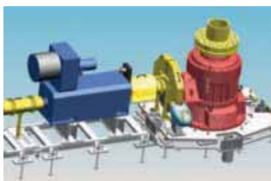
Abb. 2: Schemazeichnung des Leitner-Unterflurantriebes mit einseitigem Eintrieb in das vierstufige Planetengetriebe
