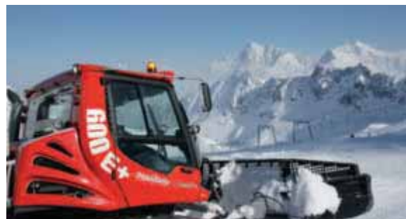
PistenBully 600 E+ – das erste Pistenfahrzeug mit diesel-elektrischem Antrieb im alpinen Einsatz.
