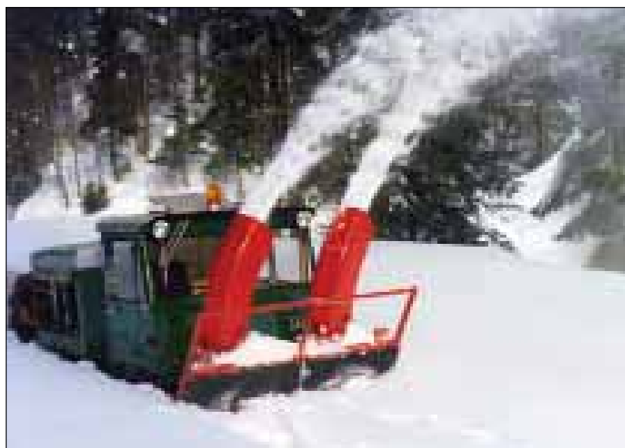
Eine Innovation: Fritz Zurbrügg entwickelte eine gelenkig fahrende Schneefräs-Maschine
