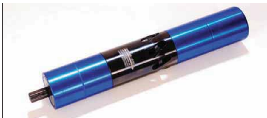
Abb. 2: Das patentierte Reibwerkzeug GeroVari Reamer funktioniert wie eine herkömmliche Maschinen-Reibahle. Es ist verstellbar (bis +0,3 mm), unterscheidet sich aber durch einen Schäl-Anschnitt und die speziell geformten, links gedrehten Schneiden für ein „weiches“ Reiben
