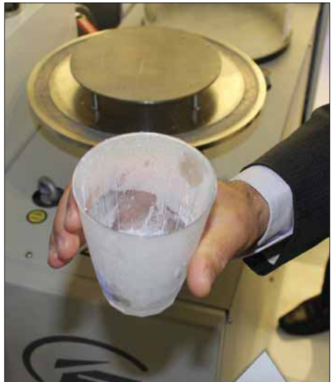
Das physikalische Prinzip, mittels Vakuum Eis & Schnee erzeugen zu können, wurde am IDE-Messestand in Bozen „live“ präsentiert: Innerhalb von Sekunden - und ohne irgendwelche Minus-Temperaturen - hat das Wasser seinen Aggregatzustand geändert
