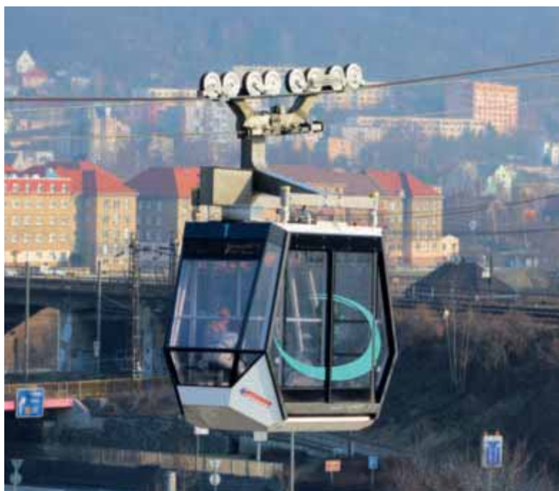
Dieser neue Kabinentyp von Carvatech wurde zum ersten Mal an der Pendelbahn Větruše verwendet. Dank der geringen Trassenneigung konnte das Kabinengehäuge kurz gebaut werden.
