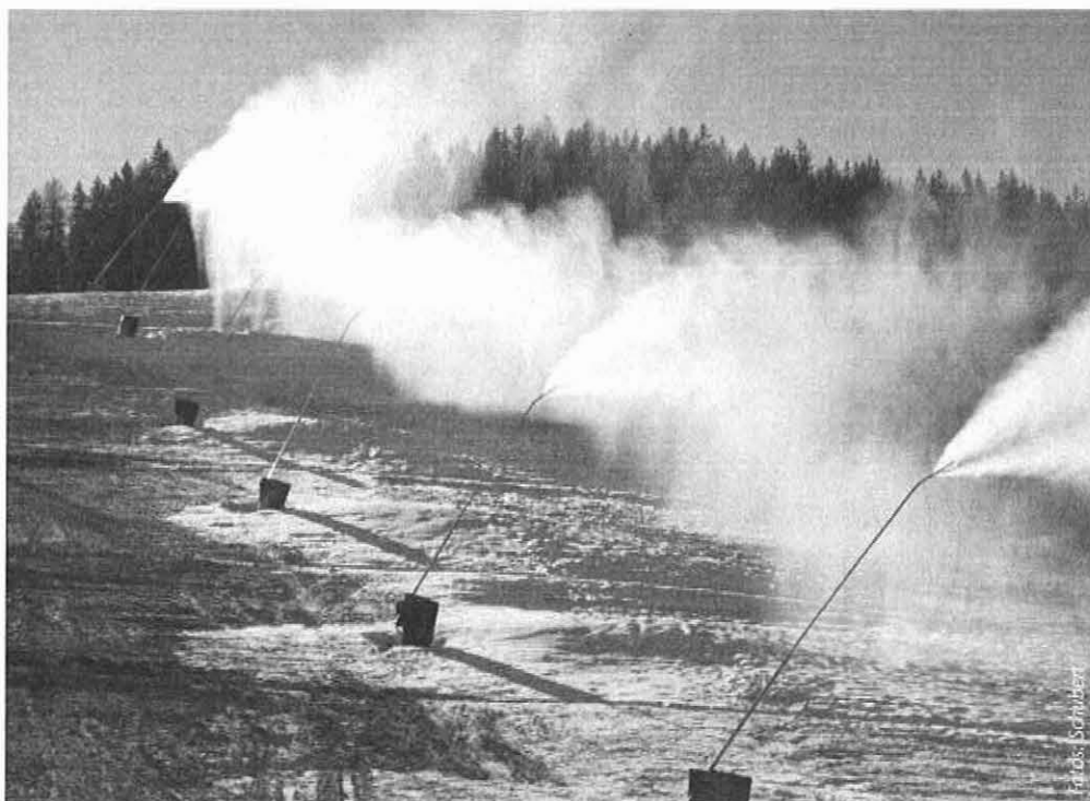
Grundbeschneigung auf der Gerlitzten mit 26 Schneilanzen von 2SNOW.
