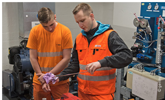
L'apprenti Cristiano Monteiro et Patrick Zimmermann contrôlent le niveau d'huile du réducteur.
